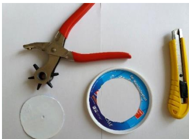
Abb. 11: Aus dem Jogurtdeckel wird eine Scheibe von \varnothing 8.5\text{cm} geschnitten und im Zentrum mit der Lochzange ein Loch gemacht
