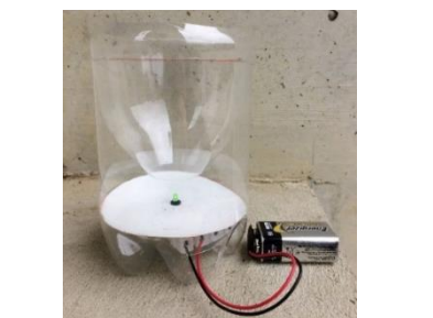
Abb. 25: Die fertige LED-Falle mit angeschlossener 9 Volt Batterie
