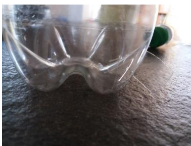
Abb. 24: Im Flaschenbodenteil wird für den Kabelaustritt noch ein kleines Fenster geschnitten
