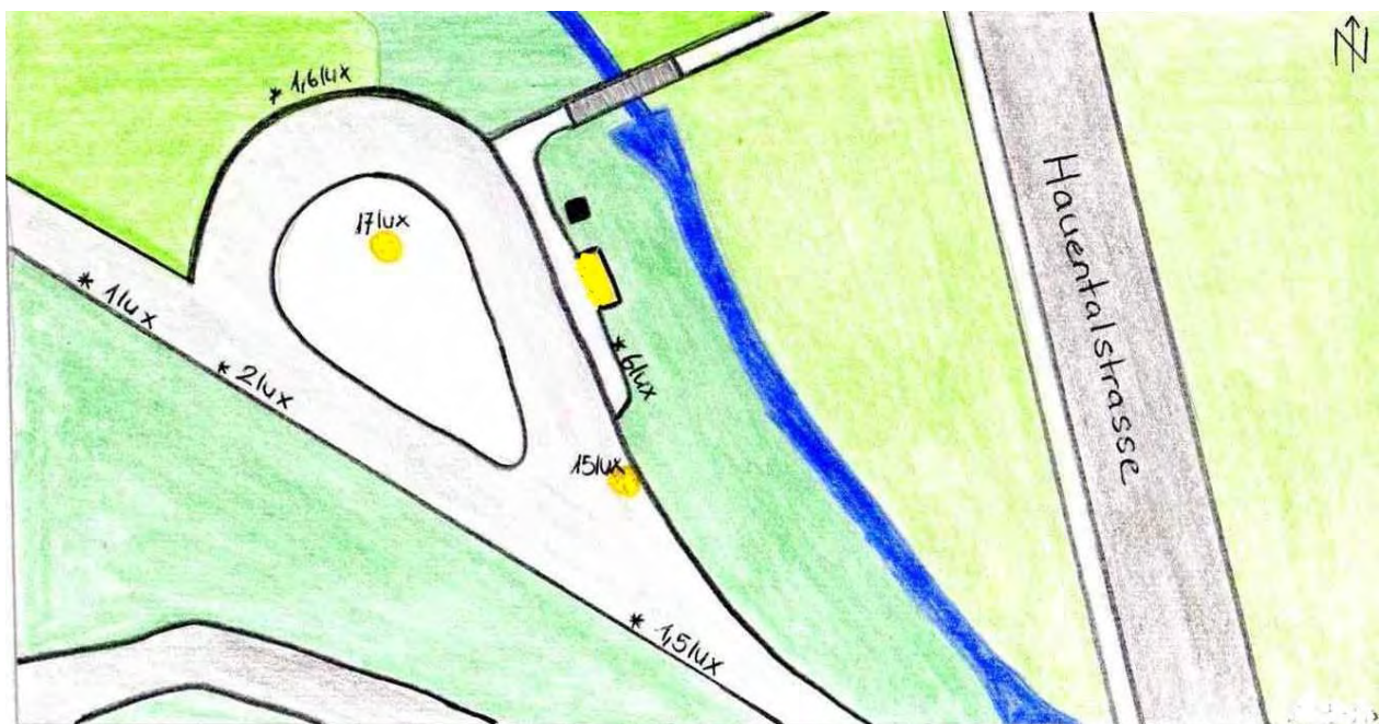
Abbildung 73: Beleuchtung der Bushaltestelle Sommerwies.
